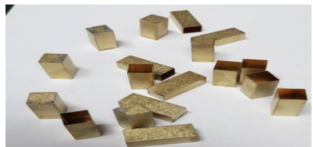
Fig. 9. Brass Case used as Outer Shape of Sensor Mechanism. 그림 9. 센서 기구의 외형으로 사용된 황동 케이스
