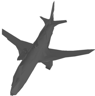
Fig. 12. Example of mesh surface creation using vertices and faces information. 그림 12. 꼭짓점과 면 정보를 이용한 mesh 표면 생성의 예시
